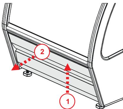
**B** Para darle mantenimiento y/o limpieza al condensador use aire a presión.
