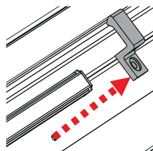
**D** Para colocar la lámpara nueva, repita los pasos de manera inversa.
