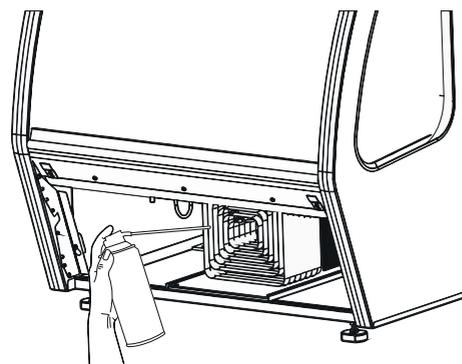
**C** Al terminar de darle mantenimiento al condensador, repita los pasos de manera inversa.
